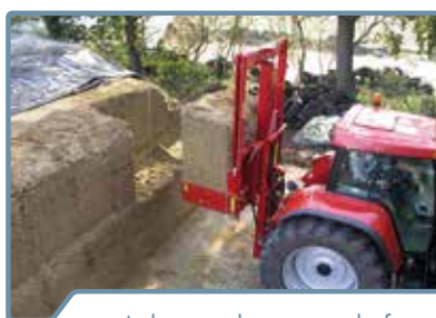
Achteraanbouw met hefmast
