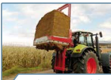
Achteraanbouw met hefmaat
