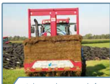
Achteraanbouw met hefmast
