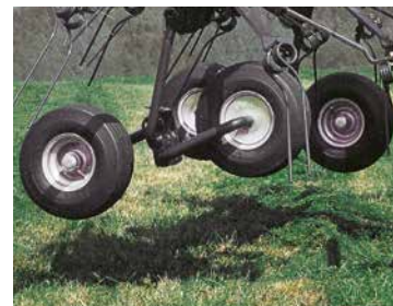
Optionele tandmassen verbeteren de bodemaanpassing voor de Fanex 464 en Fanex 524.
