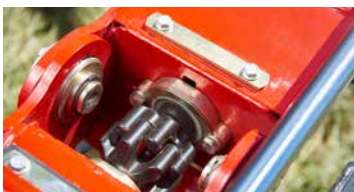
Dankzij de Vicon HexaLink vingerkoppeling kunnen de rotoren 180° worden opgevouwen voor transport.
