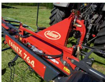
Sterk en robuust hoofdframe met V-vormige aanbouwboek.
