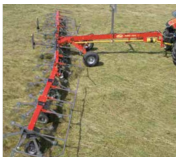
Voor het kantschudden kunnen de buitenste 3 rotoren hydraulisch naar binnen worden gezet.
