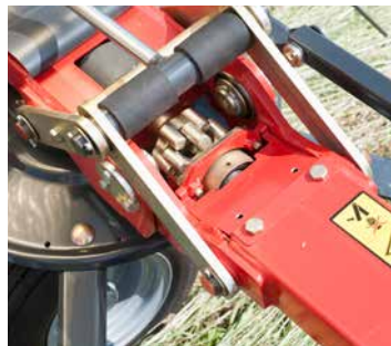
Met de Vicon HexaLink vingerkoppeling kunnen rotoren 180° worden opgeklapt voor transport.
