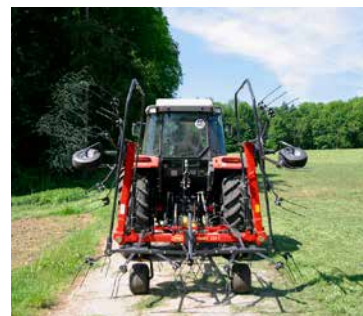
Tijdens het hydraulisch opklappen voor transport, gaan de tanden automatisch ophoog.
