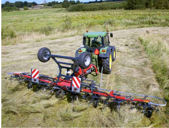
Haal meer uit uw gewas. Met kantschudden houdt u het gewas in het veld. De schudder wordt hydraulisch in kantschudpositie gezwenkt, waardoor het gewas eenvoudig van de perceelsrand af kan worden geschud.
