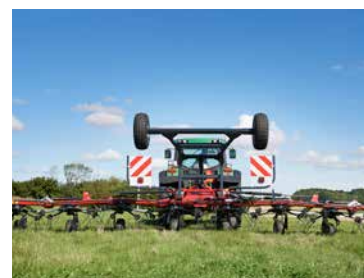
De Fanex 904C en 1124C is standaard voorzien van brede 10.0/75 15.3 transportbanden met een grote spoorbreedte van 2.45m.
