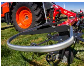
Aluminium bescherm-beugels, welke licht in gewicht zijn, maar enorm sterk en vormvast.
