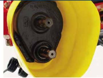
Optioneel met reductie-tandwielkast voor nachtzwaden.
